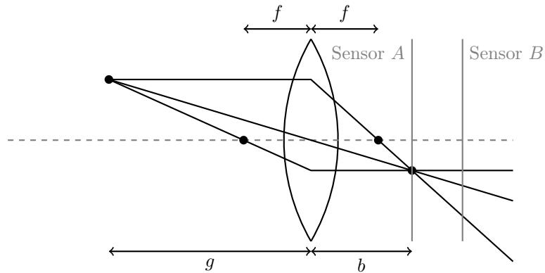
Der Gegenstand wird auf Sensor  $A$  also scharf abgebildet, nicht aber auf Sensor  $B$ .
